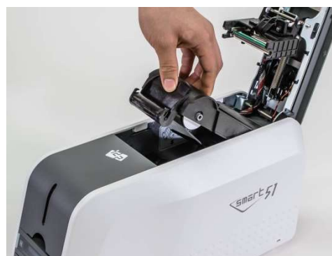
図16 リボンカートリッジを取り付けます
