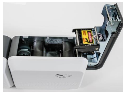
그림 23 라미네이터 필름 장착 3
